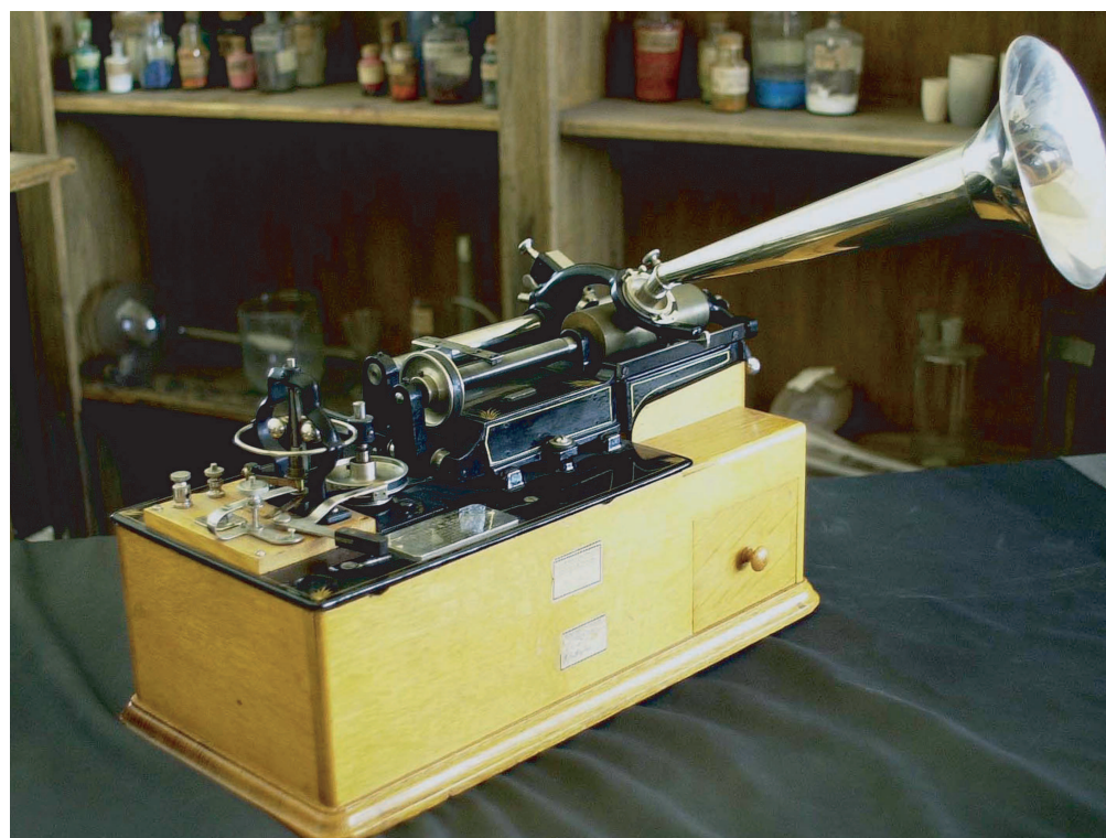
FIG. 8.5 – Phonographe Edison dont on distingue à gauche le régulateur Pickering (voir son agrandissement en 8.4).
